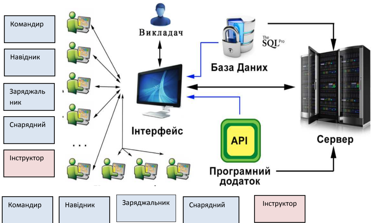
Рис. 3 Спрощена структурно-функціональна схема віртуального тренажера підготовки обслуги міномета
