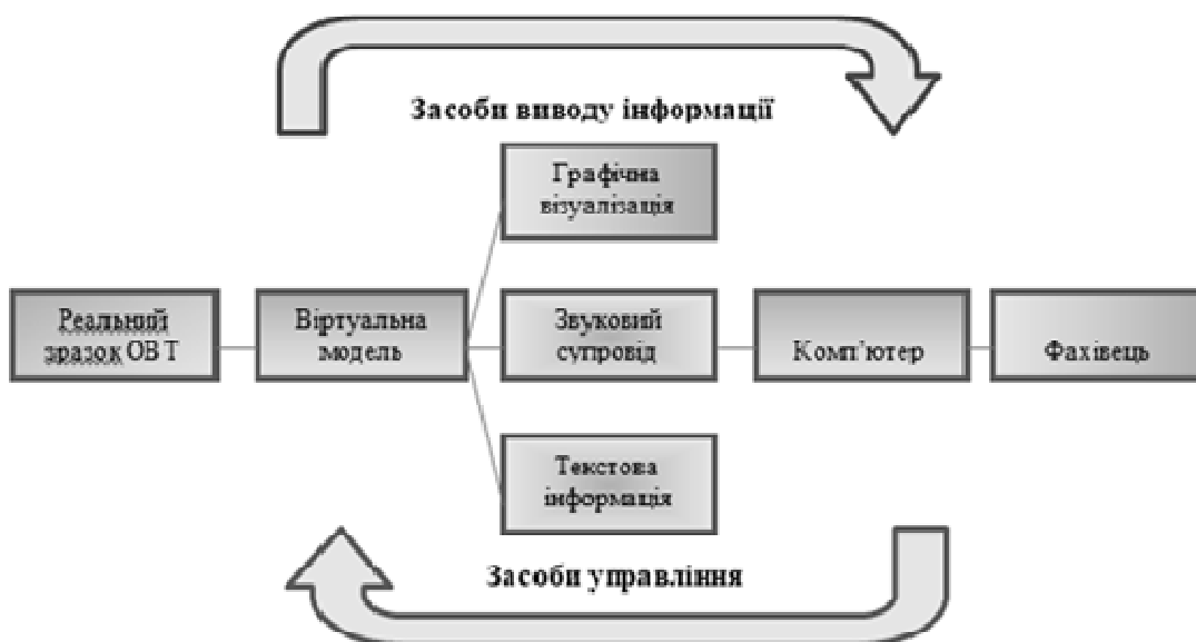
Рис. 6. Спрощена схема принципу роботи віртуального тренажера
