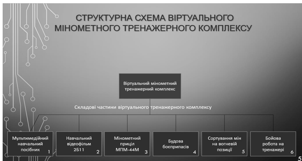
Рис. 3 Структурна схема віртуального мінометного тренажерного комплексу
