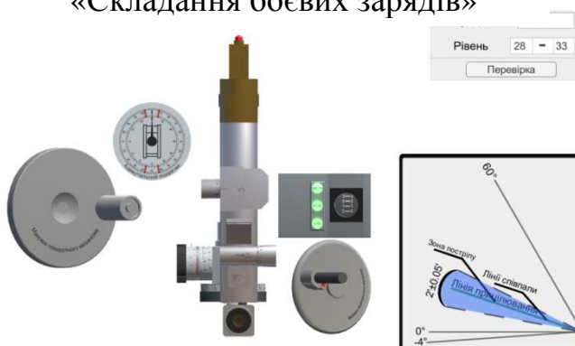
Рис. 6 Віртуальний тренажер прицілних пристроїв 152-мм САУ 2С3М: а – загальний вигляд тренажера; б – наведення на ціль.
