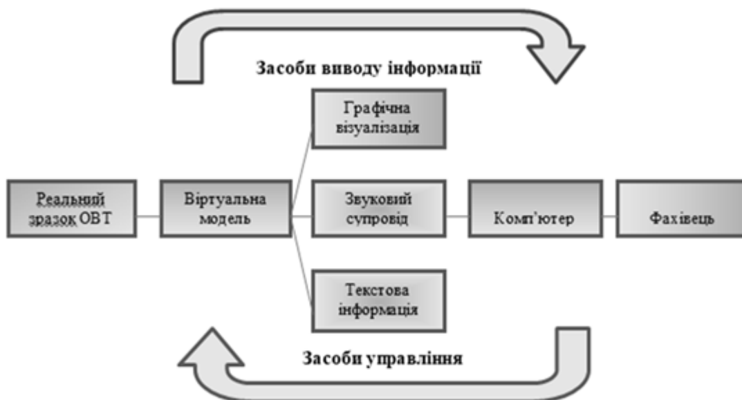
Рис. 6. Спрощена схема принципу роботи віртуального тренажера
