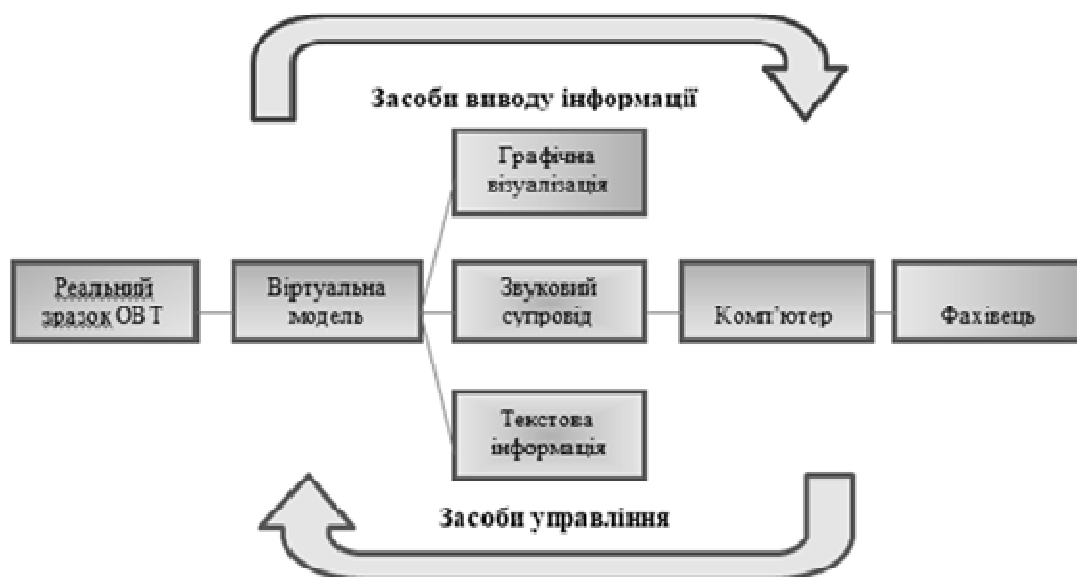
Рис. 6. Спрощена схема принципу роботи віртуального тренажера
