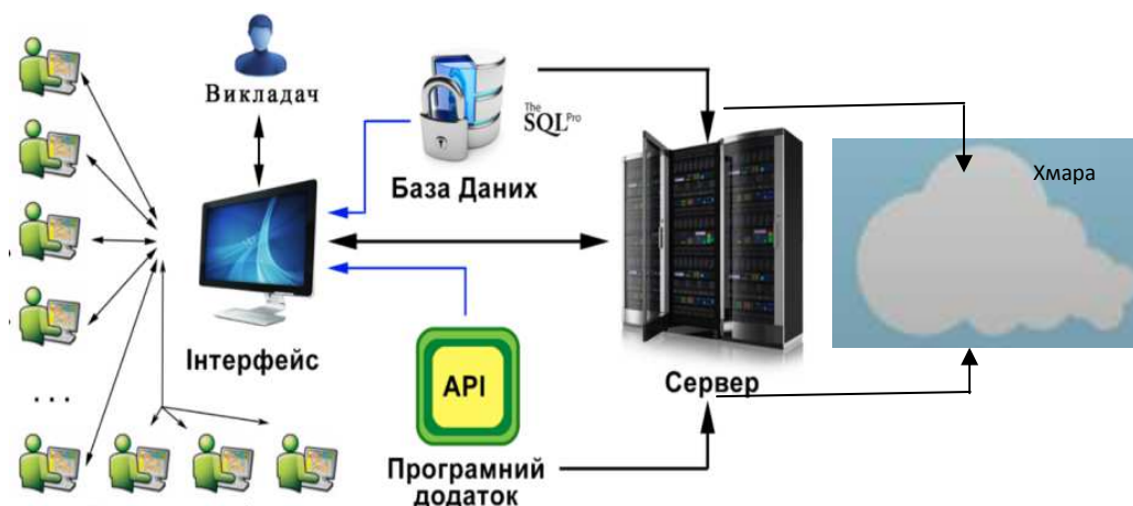
Рис. 2. Спрощена загальна структурно-функціональна схема віртуального тренажера
