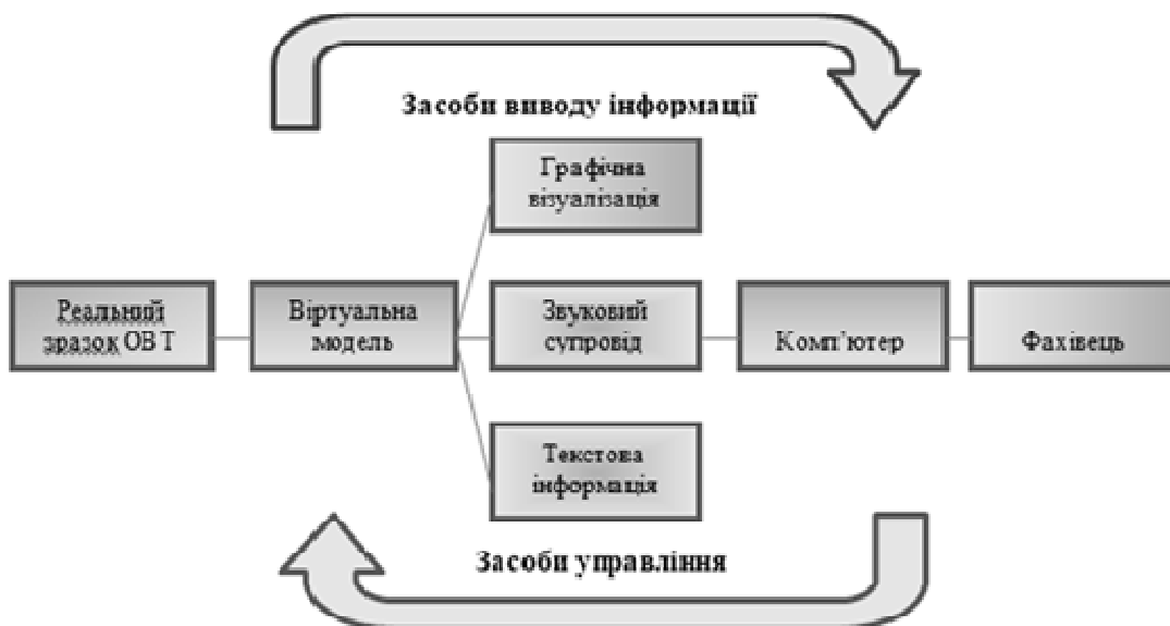
Рис. 6. Спрощена схема принципу роботи віртуального тренажера
